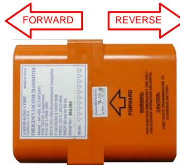
**Figure 25-20 G-switch Test Motion**
